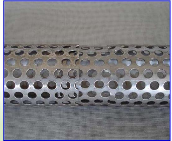
**Foto 1** – Rohr mit Löcher – Detail der Verbindung zwischen 2 Stücken
